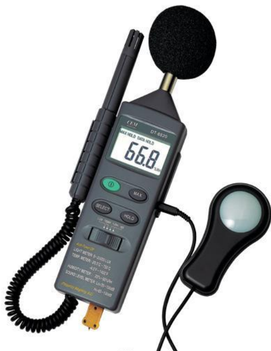
2.17-р зураг. DT-8820 шумомер, хэмжилт хийж буй байдал
